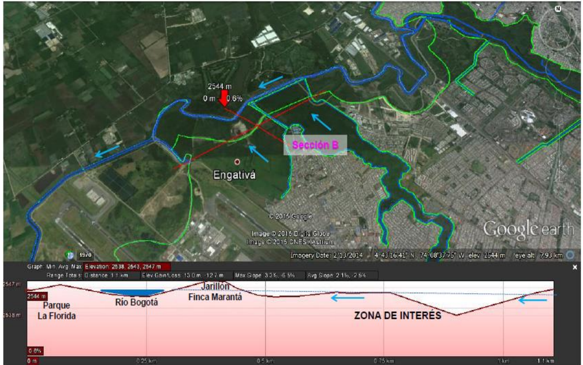
Imagen No. 12. Perfil longitudinal (sección B) Zona de interés humedal Jaboque Fuente: ajustado de Google Earth – 2014.
